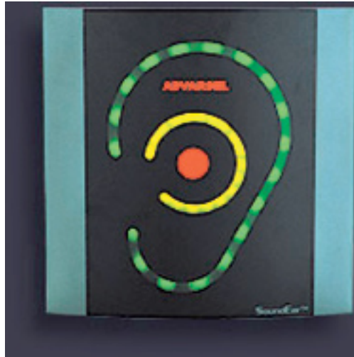
Mynd 1. „Eyrað“ er lampi, sem lýsir með gulu ljósi við 80 dB hávaða, en rauðu ljósi við 85 dB. www.soundear.dk
